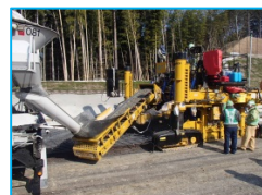
生コン車から投入されたコンクリートが平らに敷き均されて出てきます。
