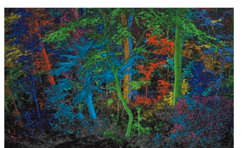
技術研究所内の雑木林の点群データ。木々ごとにIDを振り、色分けで表現。
