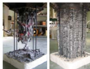
耐火試験後の様子 (左:準耐火構造の集成材 右:シグマウッド)
