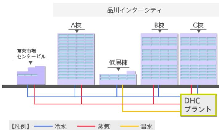
図1:地域冷暖房施設系統図
