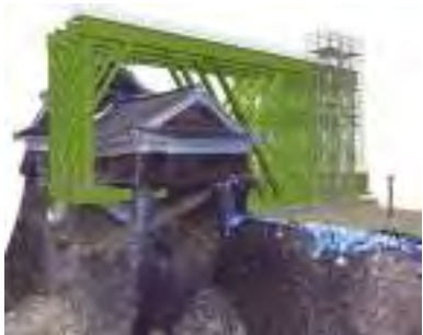
熊本城 点群データとBIMモデルの合成
