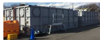
図8 薬剤槽(大型水槽)
