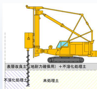
原位置不溶化処理の模式図
