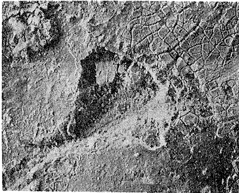
写真一1 孔食部二次電子像 (×100)
