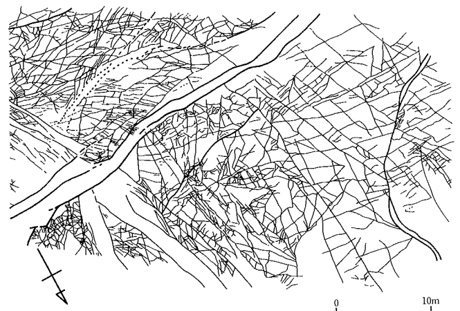
図-1 地質情況 (亀裂マップ)
