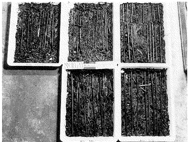
写真-5 無処理萱の腐朽促進12か月後の状況
