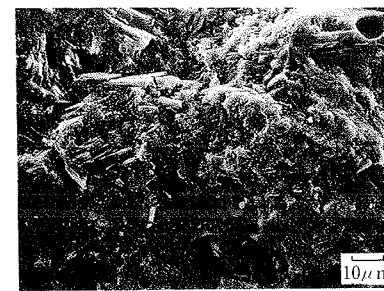
写真-8 液体窒素で0°Cまで冷却 した硬化体破面 (材令13週)
