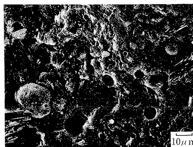
写真-7 材料冷却の硬化体破面 (材令13週)
