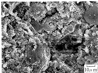
写真-4 液体窒素冷却の硬化体 破面 (材令1週)
