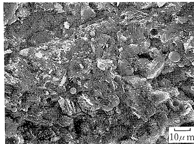
写真-2 冷却なしの硬化体破面 (材令4週)
