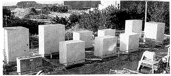
写真一 試験体暴露状況
