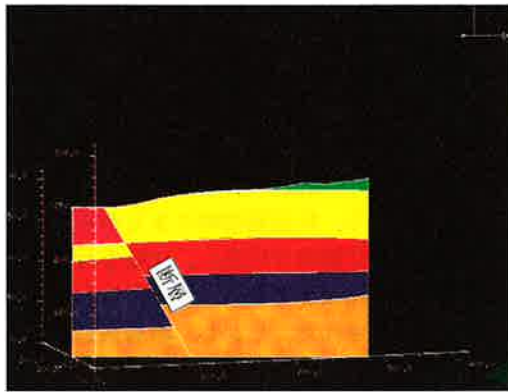
写真-2 地質断面図による断層の傾斜の表現
