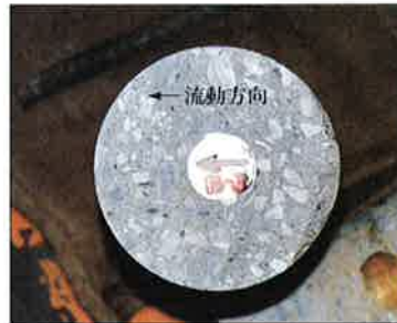
(a)鉛直筋まわりの充填状況
