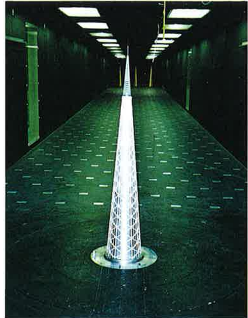
写真二 風洞内に設置した模型（縮尺1/500）
