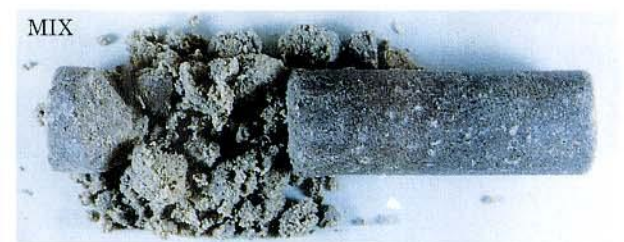
写真-4 試験体の変質状態
