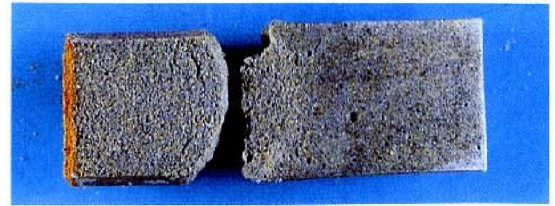
写真-3 試験体断面の変質状態
