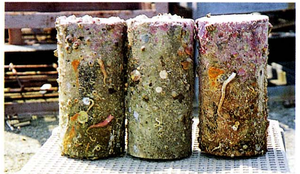
写真-1 コンクリートの表面状態
