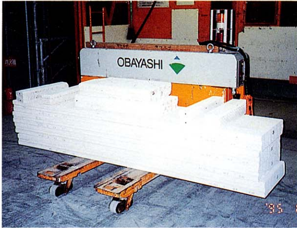
写真-1 移載装置 (ALCの積み込み)
