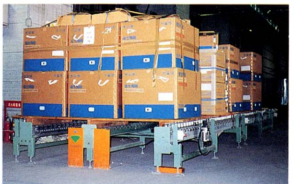
写真-6 ローラーコンベアによる搬送
