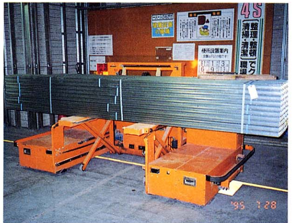
写真-4 無人搬送車による水平搬送
