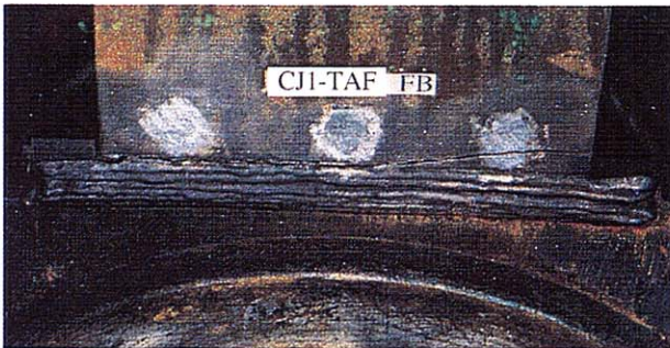
3) 充填溶接した小形スカラップ工法の動的荷重した試験体 (CJI-TAF) Revised Tiny Scallop Specimen with Fillet Welding Tested by Dynamic Loading
