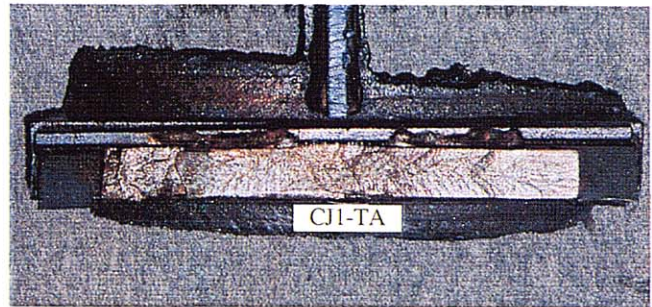
2) 小形スカラップ工法の動的荷重した試験体 (CJI-TA) Revised Tiny Scallop Specimen Tested by Dynamic Loading
