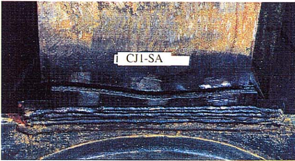
1) スカラップ工法の動的荷重した試験体 (CJI-SA) Standard Scallop Specimen Tested by Dynamic Loading
