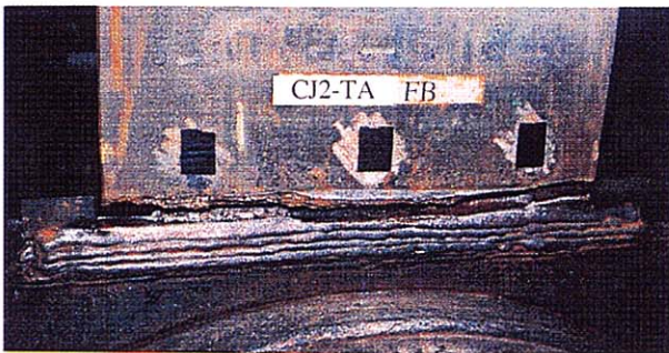
4) 小形スカラップ工法の静的荷重した試験体 (CJ2-TA) Revised Tiny Scallop Specimen Tested by Static Loading
