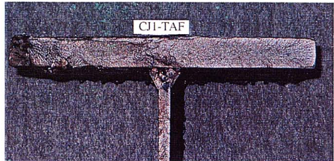
3) 充填溶接した小形スカラップ工法の動的荷重した試験体 (CJI-TAF) Revised Tiny Scallop Specimen with Fillet Welding Tested by Dynamic Loading
