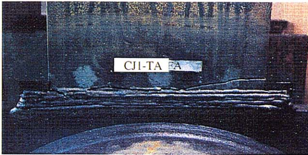
2) 小形スカラップ工法の動的荷重した試験体 (CJI-TA) Revised Tiny Scallop Specimen Tested by Dynamic Loading
