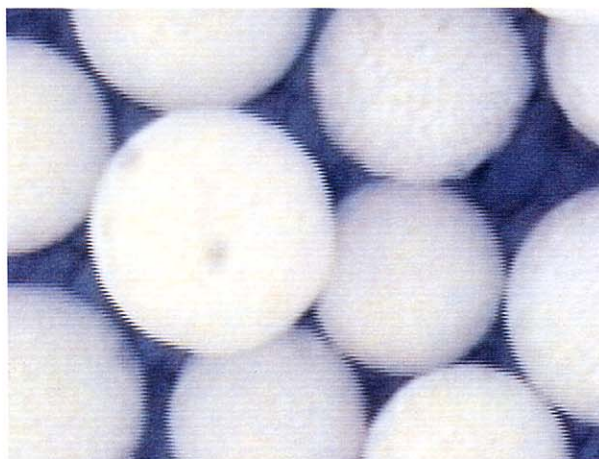
Photo 1 微粒子発泡ポリスチレンビーズ顕微鏡写真 (×27倍) Microphotograph of Fine Expanded Polystyrene Beads (×27)
