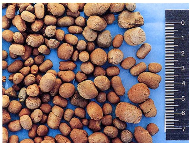
Photo 2 超軽量粗骨材「スーパーメサライト」 Ultra-Lightweight Coarse Aggregate "Super MESALITE"
