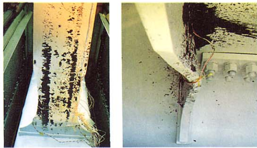
(a) フランジの降伏 (b) 局部座屈 Photo 3 Dの損傷状況 Damage of D Specimen
