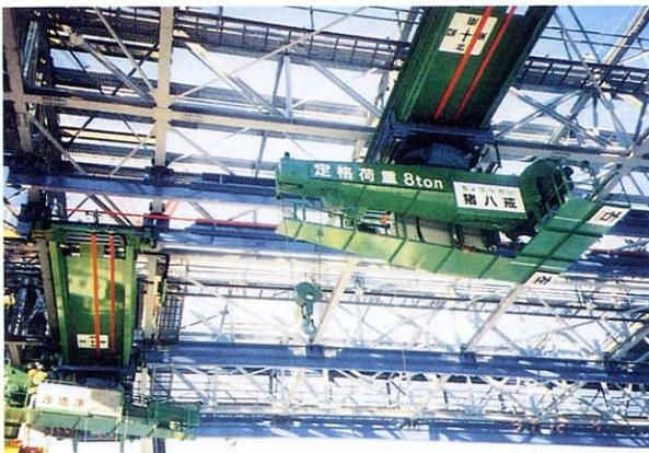
Photo 5 旋回アーム式天井クレーン
