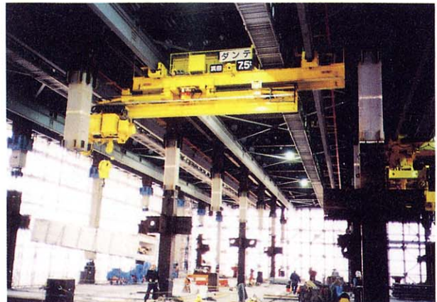
Photo 4 スライドアーム式SCFクレーン SCF Crane with a Elastic Arm
