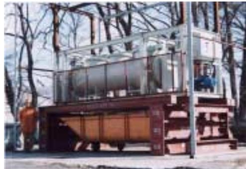
Photo 1 ドラム反転型試験機(1.6m<sup>3</sup>)
