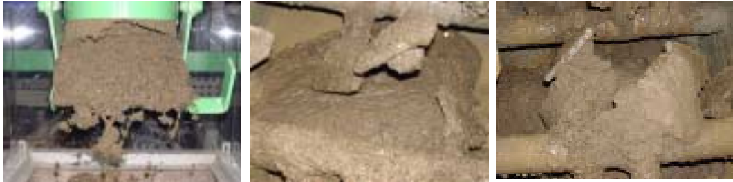
水浸細骨材の排出状況 締固め無しで作製した場合 締め固めて作製した場合
