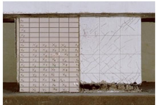
Photo 3 破壊後のインターネット工法によるタイル張り Appearance of Tiling Utilizing a Fabric and Anchor Pins
