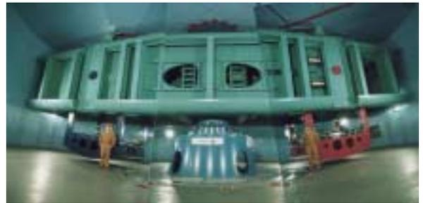
Photo 1 遠心模型実験装置
