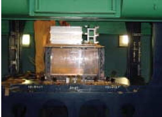
Photo 2 静的バケツトおよび中型土槽
