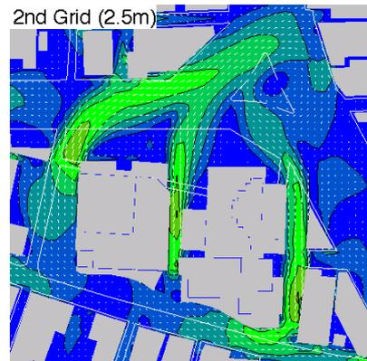
Fig. 9 地上3.5mにおける風速分布 風向：SW
