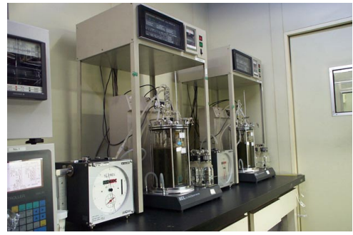
Photo 2 5L型ジャーフェルメンター試験装置 5L Type Jar Fermenter
