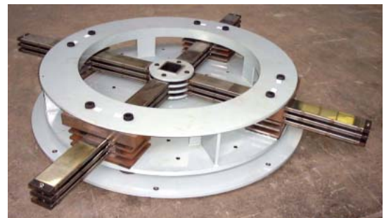
Photo 1 多段型摩擦ダンパー準実大試験体 Semi-actual-sized Specimen of MLFD
