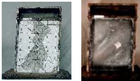
Photo 1 破壊状況例(No.8) (右はコンクリート除去後) Example of Destruction
