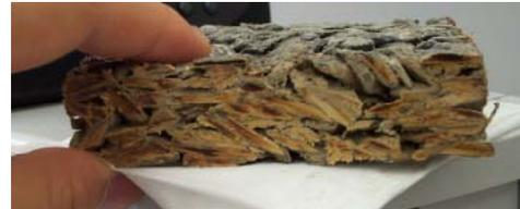
Photo 1 「チップクリート板」の断面
