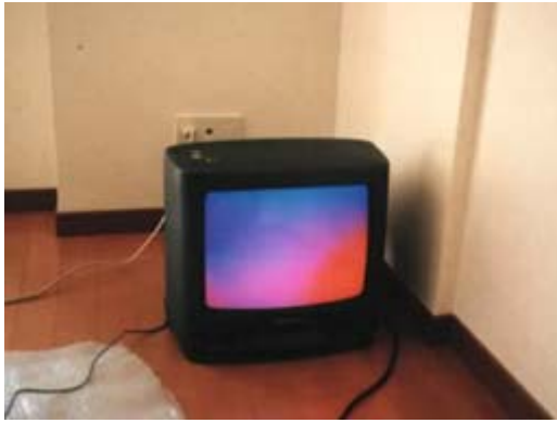
Photo 1 点A 2での色ずれ障害 TV Screen Color Error at Point A2
