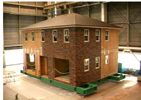
Photo 2 実大木造住宅耐震実証試験
