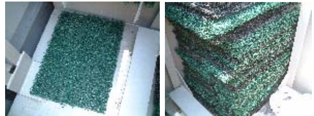
Photo 1 減衰付加材ヘチマロン Supplemental Damping Device "Hechimaron"
