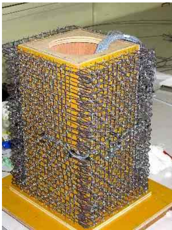
Photo 1 配筋状況 (ボックスカルバート型試験体) Arrangement of Reinforcing Bar
