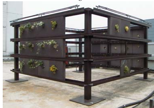
Photo 1 多機能緑化壁システム試験体 Model of Multipurpose Greening Wall
