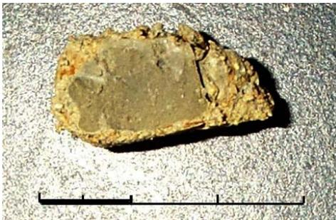
Photo 1 炭酸化処理後の土塊断面 (最小目盛5mm)
