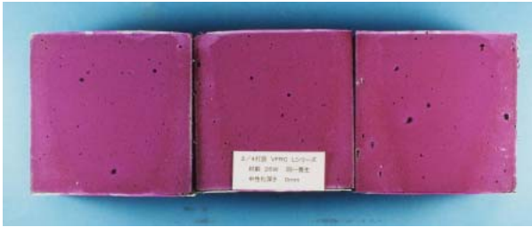
Photo 2 中性化試験結果 (VFRC-SL) Test Result of VFRC-SL Carbonation
