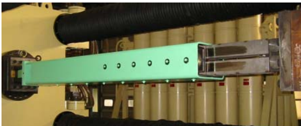
Photo 4 ユニット型免震用ブレーキダンパーの性能確認試験（カバーの無い状態） Test of the Factory Production Brake Damper
