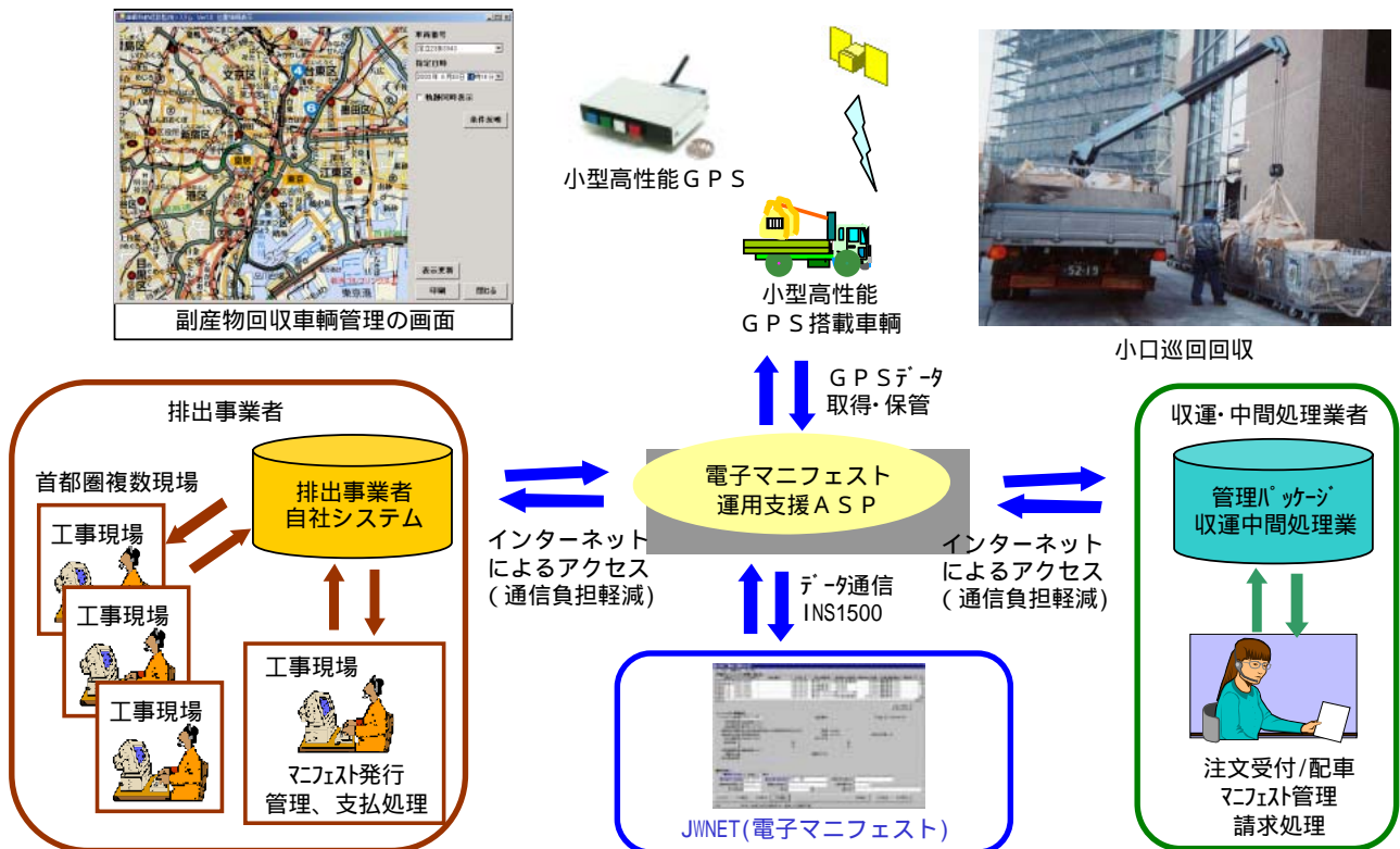
Fig. 1 建設系廃棄物の小口巡回回収と電子マニフェストシステムの全体概念 Concept of Logistics System for Construction Waste
