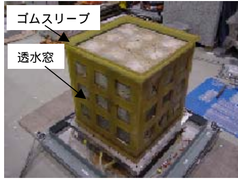
Photo 1 大型岩盤ブロック試験体 ( 0.5m立方体 ) A Large Rock Block Specimen
