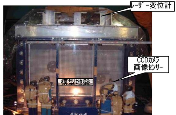
Photo 2 模型地盤と土槽
