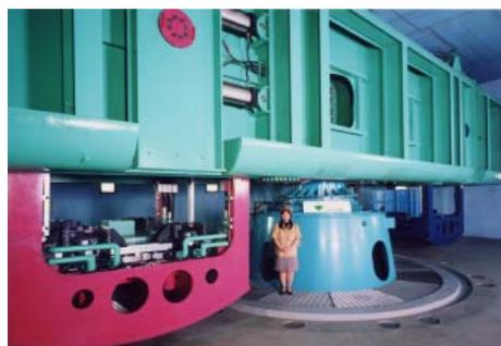
Photo 1 遠心模型実験装置
