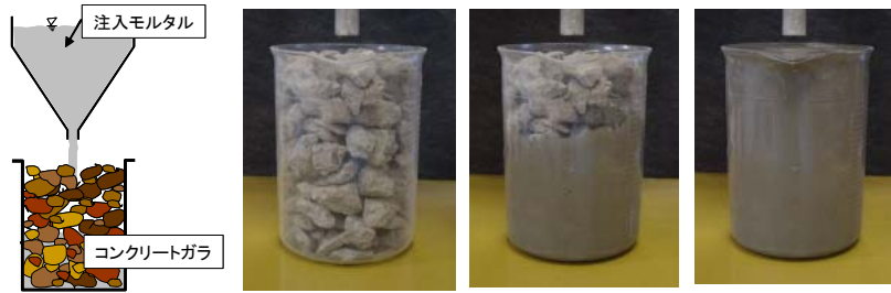
Fig. 7 注入モルタルの充填性確認状況
