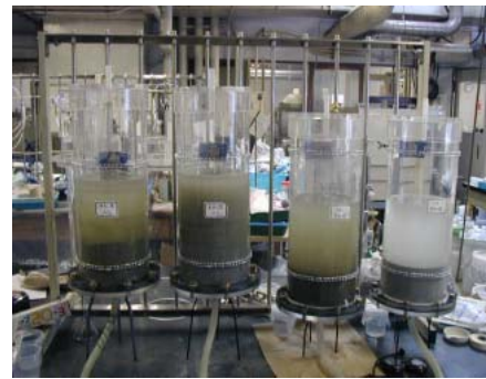
Photo 2 カラム通水試験の状況 Experiment Condition of Column Flow Test
