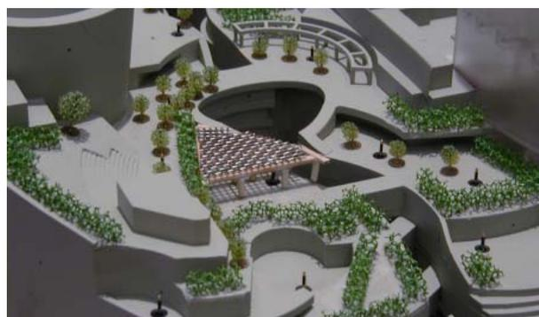
Photo 2 屋上の防風対策を目的とした縮尺模型
