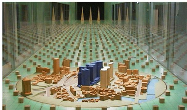
Photo 1 風洞実験による予測
