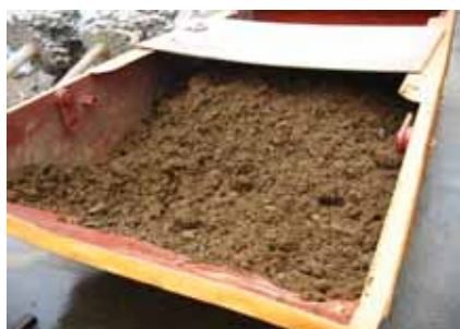
Photo 1 使用した六価クロム汚染土 Cr(VI) Contaminated Soil
