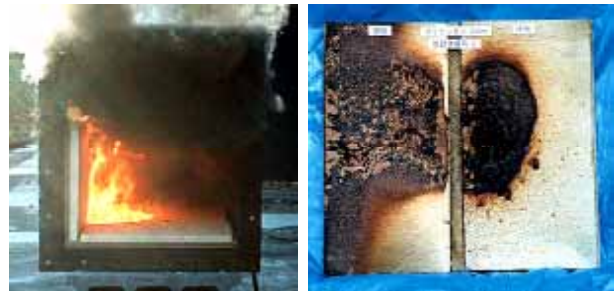
Photo 2 ポリウレタン断熱材の爆燃の様子 Explosive combustion of polyurethane foam
