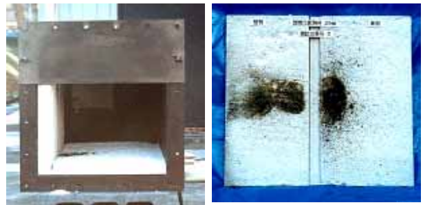
Photo 3 セラミライトエコの自己消火の様子 Self-extinguish of Ceramilite Eco
