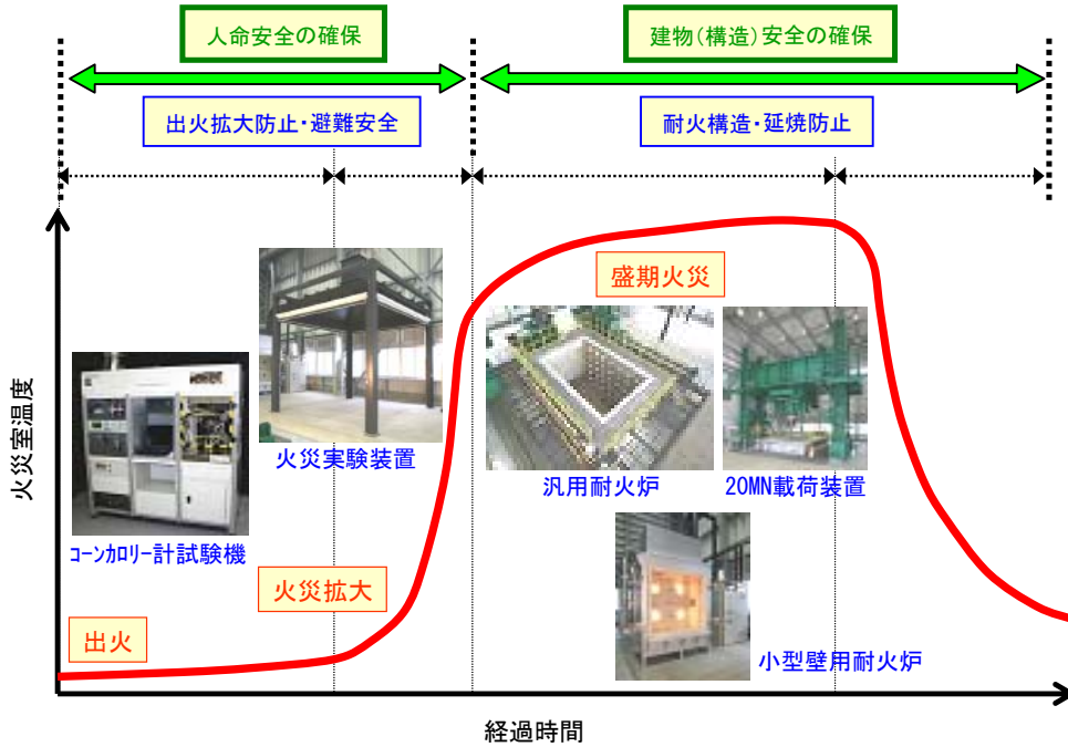
Fig. 3 火災工学実験棟に新設された実験装置の位置付け
