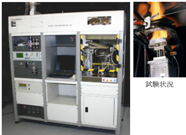
Photo 10 コーンカロリー計試験機 Cone Calorimeter
