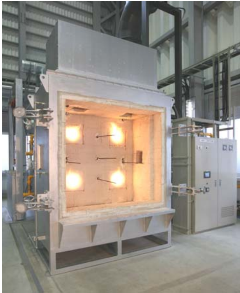
Photo 8 小型壁用耐火炉 Wall Test Furnace
